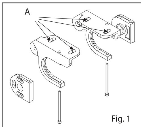
Le staffe di supporto sono le stesse sia per l'installazione a parete che per quella a soffitto. Esse devono essere fissate attraverso i fori A di Fig.1
